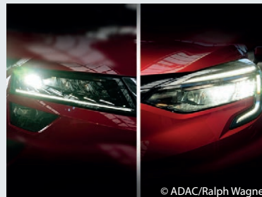
Kleine punktuelle Lichtquellen (li.) blenden stärker als Scheinwerfer mit größerer Lichtaustrittsfläche (re.)
