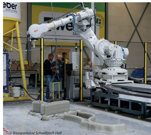
Schicht für Schicht trägt der 3D-Drucker im Werk Eindhoven (NL) das Material auf.
