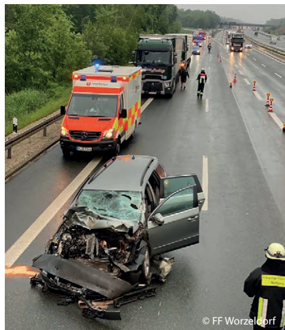
Der Pkw trug erhebliche Beschädigungen trotz des Unterfahrerschutzes am Lkw davon.
