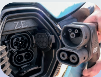
Typ-2-Ladeanschluss mit zwei zusätzlichen Pins für Gleichstrom.
