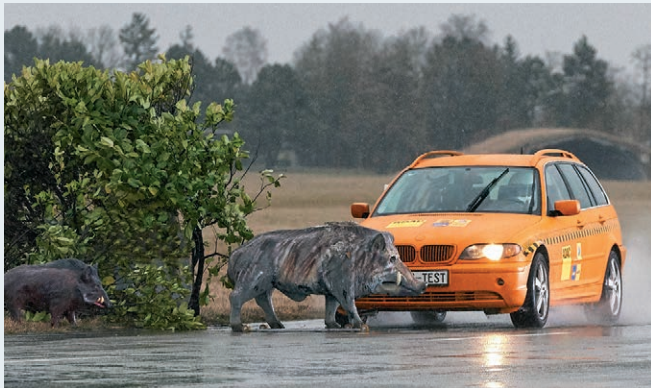
Kurz vor dem Aufprall beim ADAC Crashtest mit einem Wildschwein-Dummy
