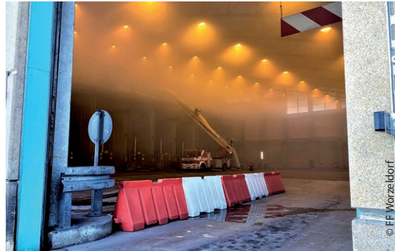
Mittels Drehleiter in der Halle wurde der angrenzende Brandraum belüftet.
