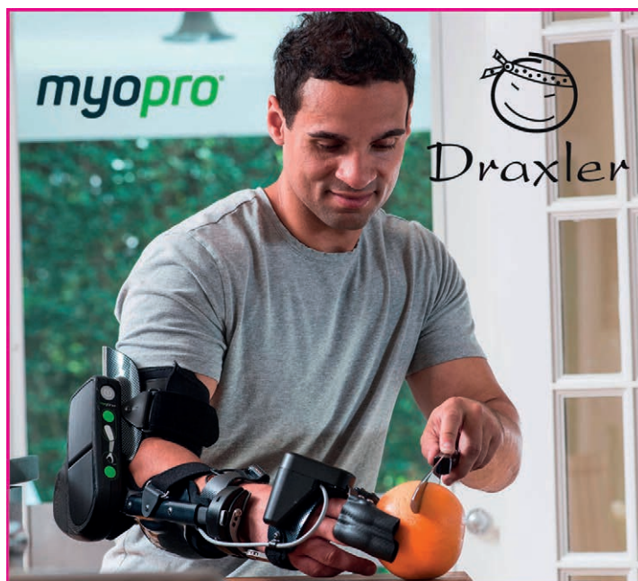
Patienten bekommen durch diese individuell angefertigte Hightech-Orthese wieder die Möglichkeit, mit ihrer Hand zu greifen und halten und ihren Ellenbogen zu beugen, heben oder strecken. Foto: © Myomo
