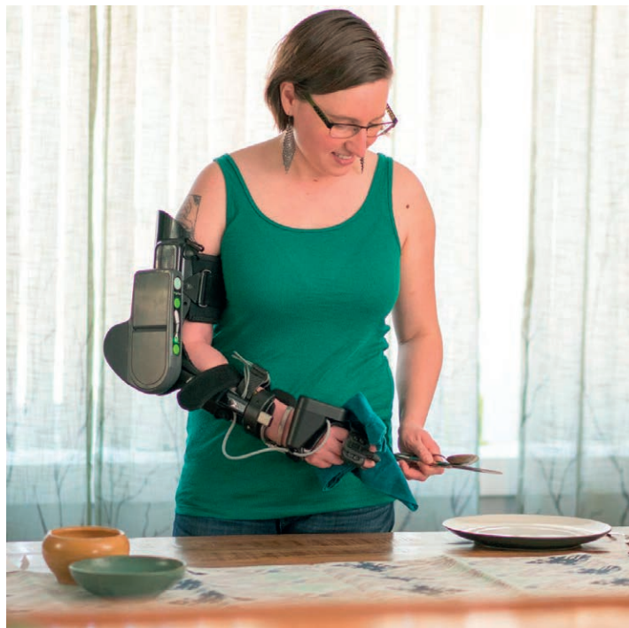
Patienten bekommen durch diese individuell angefertigte Hightech-Orthese wieder die Möglichkeit, mit ihrer Hand zu greifen und halten und ihren Ellenbogen zu beugen, heben oder strecken. Foto: © Myomo
