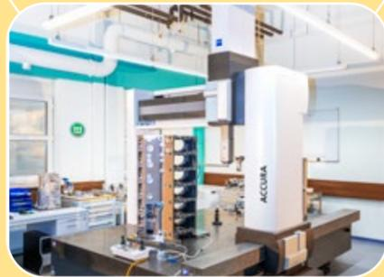
Für taktile Messungen setzen wir 4 **Zeiss** 3D-Koordinatenmessmaschinen ein. Für Serienmessungen oder große Bauteile steht uns ein maximaler Verfahrensweg in Y von 2.400 mm zur Verfügung.
