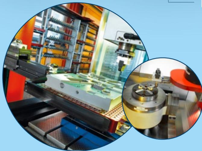
Unser **Chameleon** ist eine robotergesteuerte Fertigungsanlage mit einer Länge von 26m. In ihr arbeiten vollautomatisiert:
